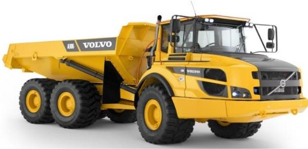
La **catégorie E** du **R482** vous permet de conduire en toute sécurité des **engins de transport** notamment les **tombereaux rigides ou articulés, moto-basculeurs > 6 tonnes et tracteurs agricoles > 100 cv.**
