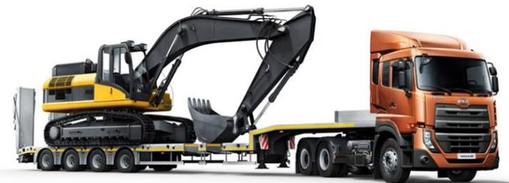
La **catégorie G** vise la conduite en toute **sécurité** des **porte-engin** est un véhicule spécialement conçu pour le transport de **matériels lourds**. Ces portes-engins sont principalement utilisés pour le transport routier d'engins qui **n'ont pas l'autorisation de circuler sur la voie publique**. Le porte-engin se compose généralement d'un **tracteur routier** et d'une **semi-remorque** ou d'une **remorque**.
